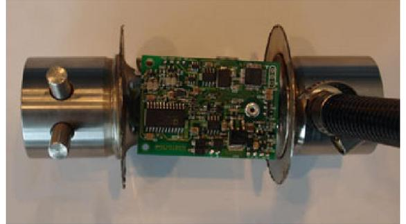
В каждом датчике установлена плата с элементами грозозащиты.
